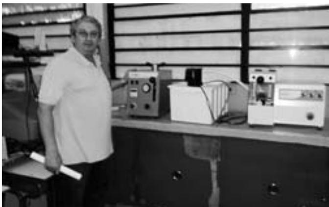
Figura 3 – Registro iconográfico de José Rubens Fogaça, em demonstração de máquinas metalográficas: embutidora de amostras e conjunto cortadora.
