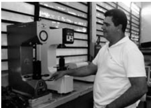
Figura 4 – Registro iconográfico de Edison Hernandez Belon, em demonstração de máquinas metalográficas: durômetro analógico e durômetro digital.
