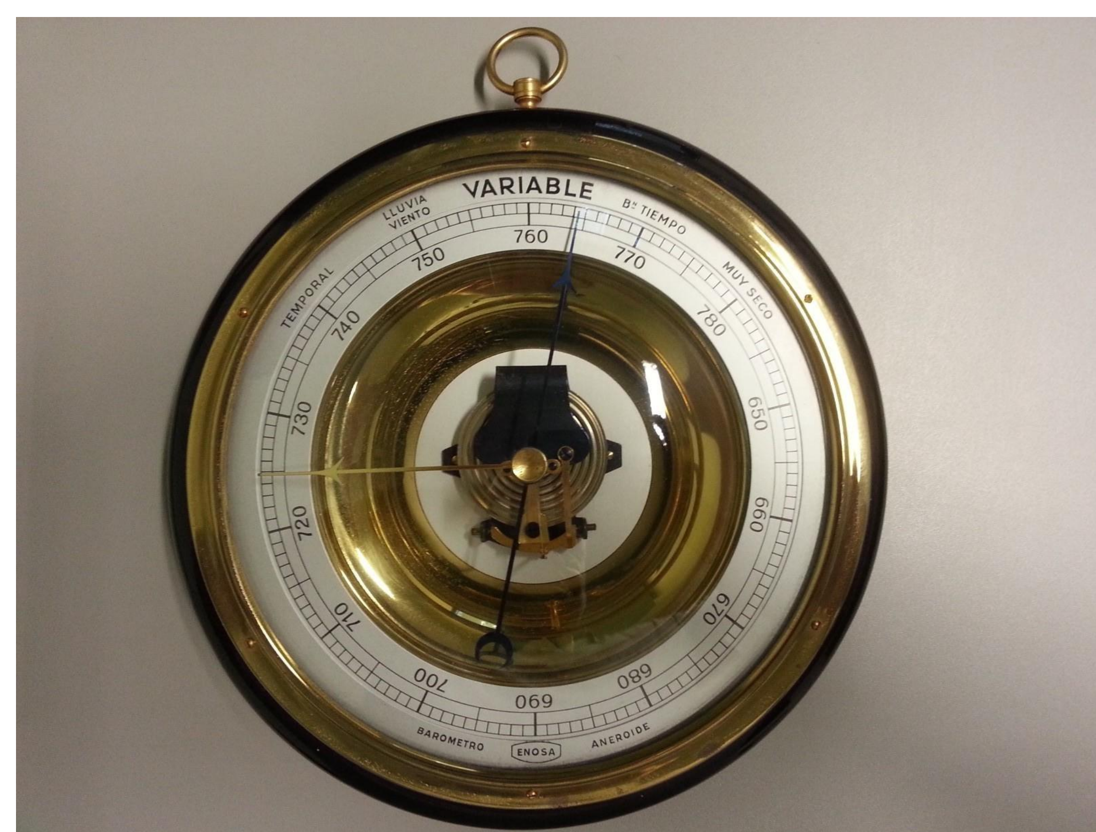
Figura 1- o barômetro aneróide aponta a situação do tempo (temporal, chuva, vento, bom tempo, muito seco) por meio da aferição de mudanças da pressão atmosférica, conforme variações da umidade presente no ar.
