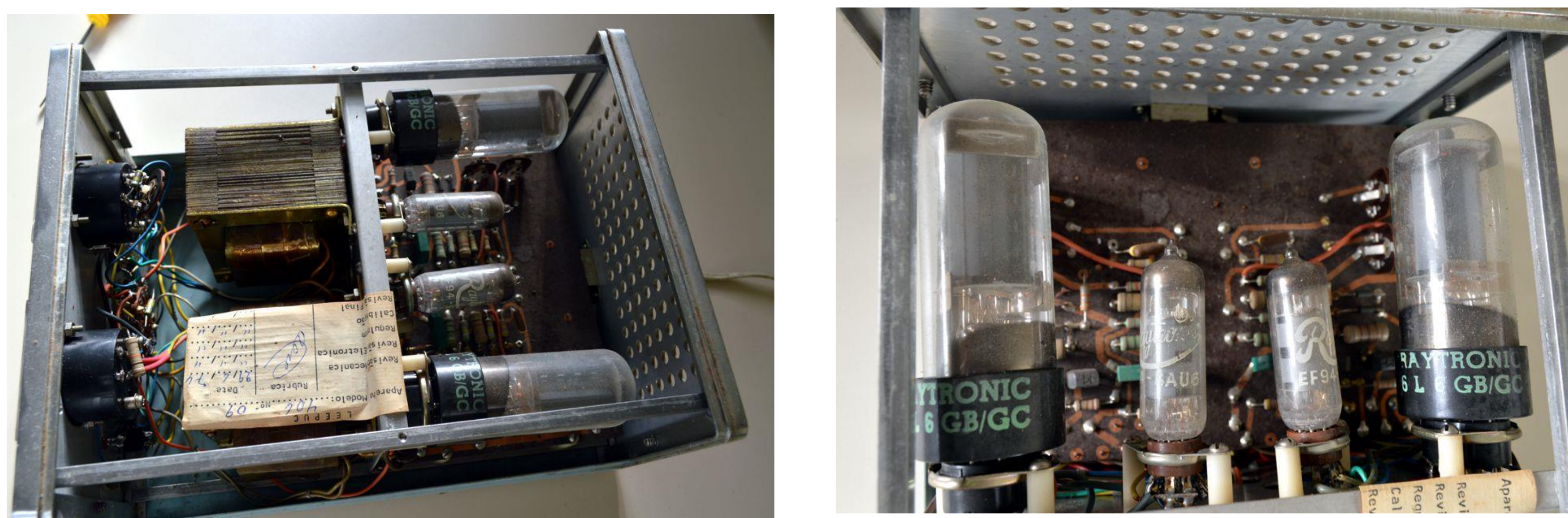
Figura 02 – Circuitos Internos da Fonte de Alimentação Dupla com detalhes das válvulas eletrônicas
