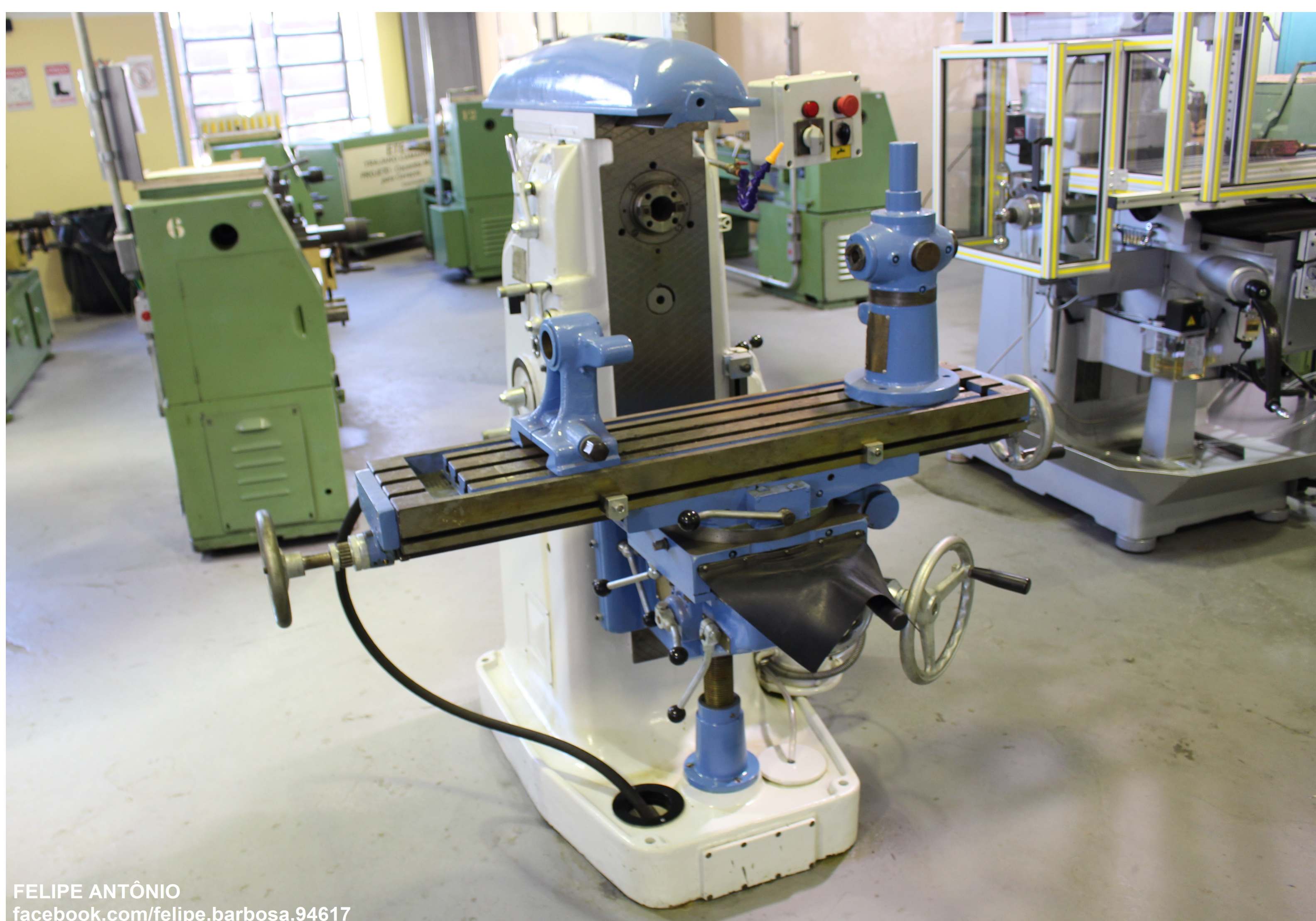
Figura 1 – Fresadora universal marca Sajo pintada em branco e azul e uma moderna fresadora, à direita. Fotografia: Felipe Antônio Barbosa de Oliveira, 11/08/2015
