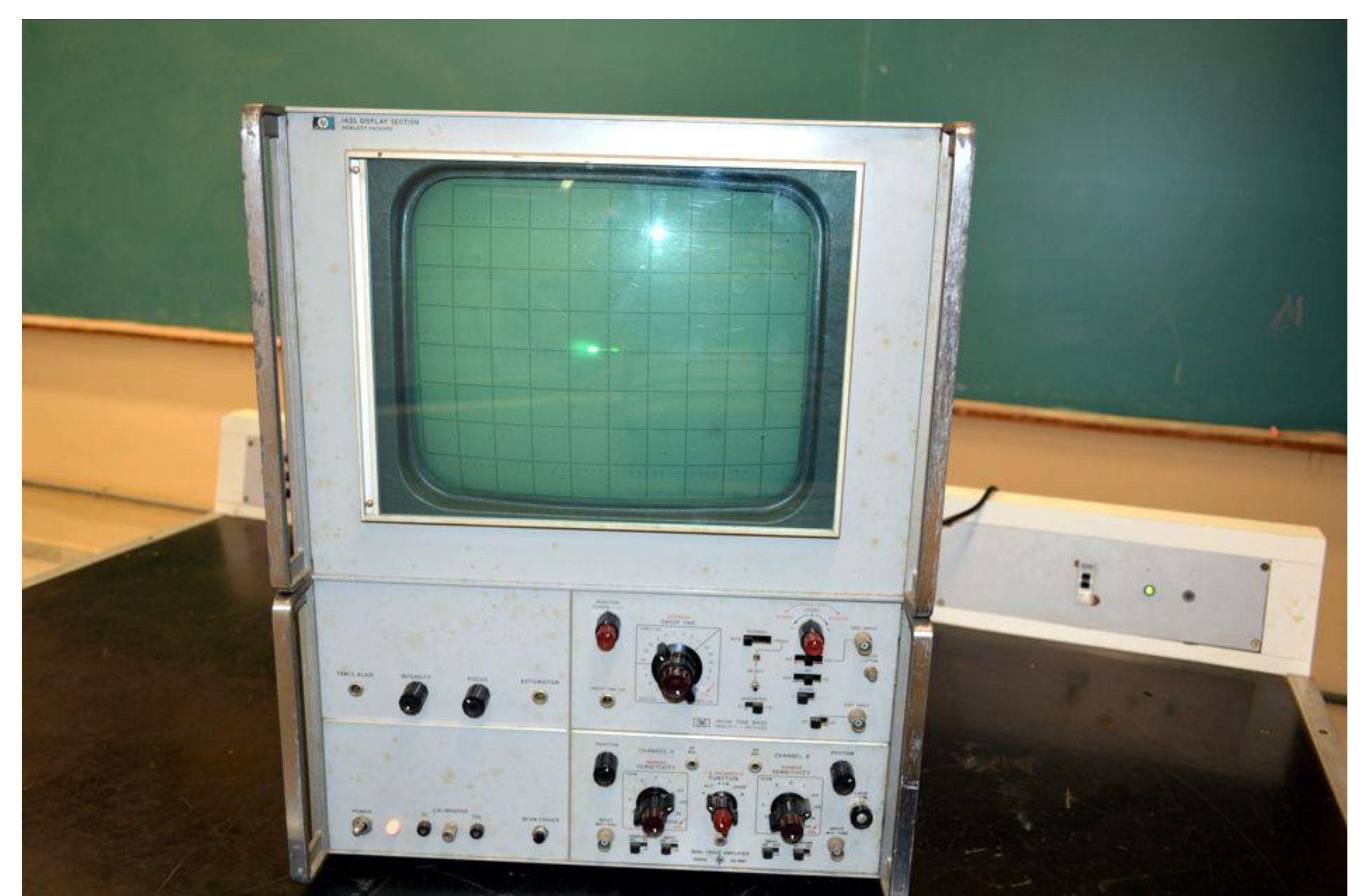
Figura 03 - Pannel Frontal Osciloscópio HP 143S Display Section - Fonte: Laboratório de Eletrônica ETEC Rosa Perrone Scavone
