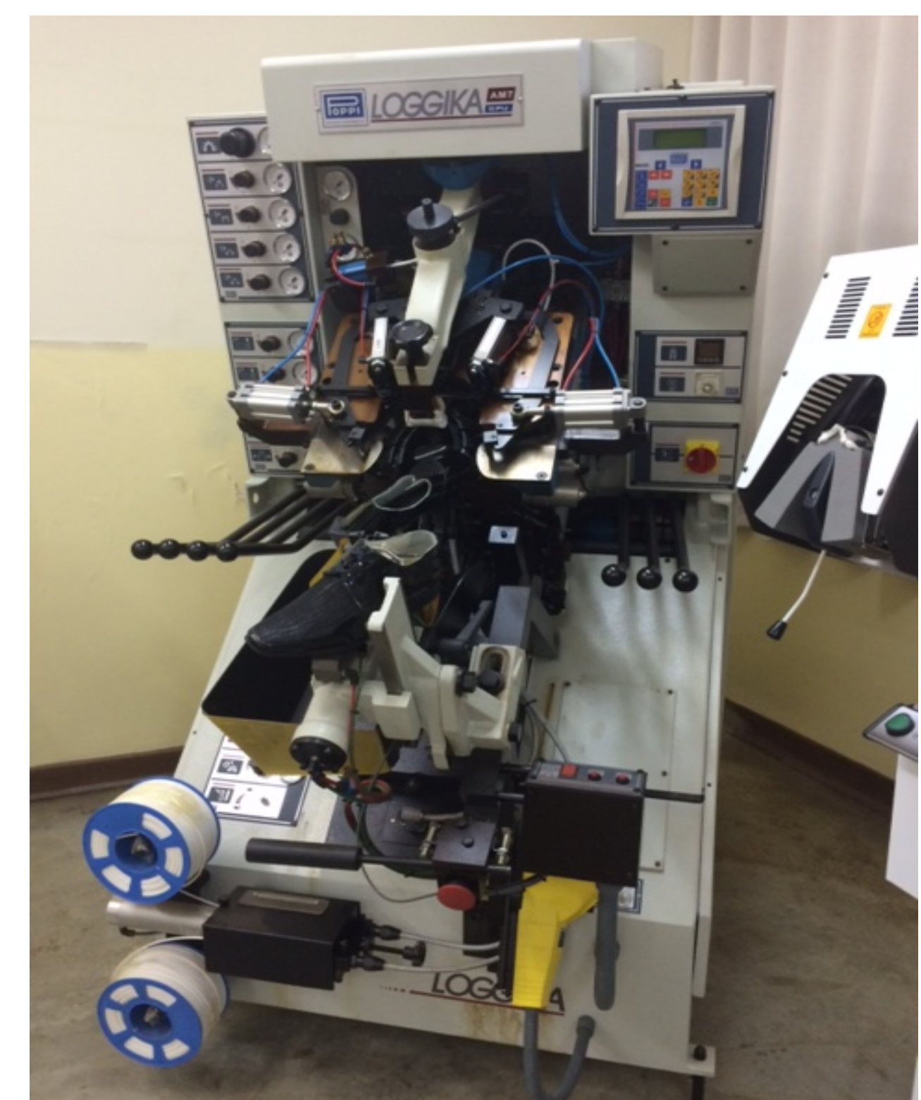
Figura 6: Molina – máquina de montagem de calçados do Laboratório de Produção da Fatec Franca
