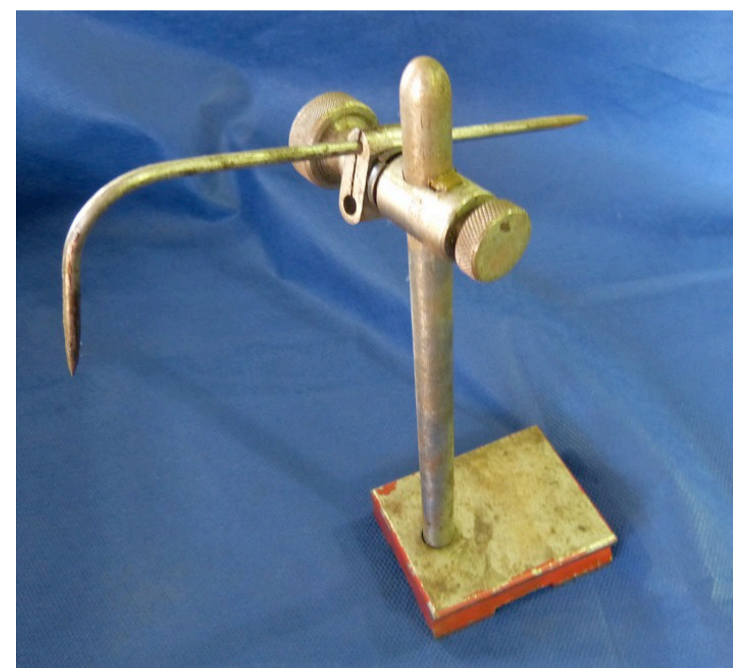
Figura 2 - Graminho (traçador de peças cilíndricas). Fotografia: Josiane Stahl, 06/04/2014.
