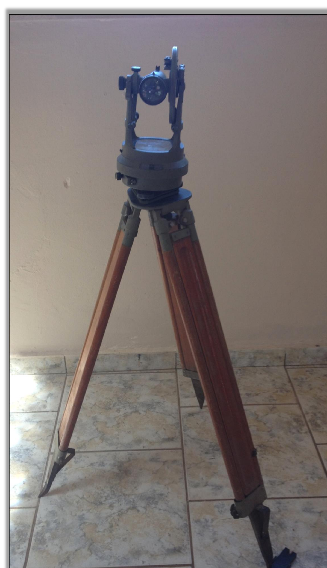
Figura 2: Teodolito Ótico Mecânico. Fonte: Acervo do Centro de Memória da Escola Técnica Estadual Professor Matheus Leite de Abreu, em 2015.
