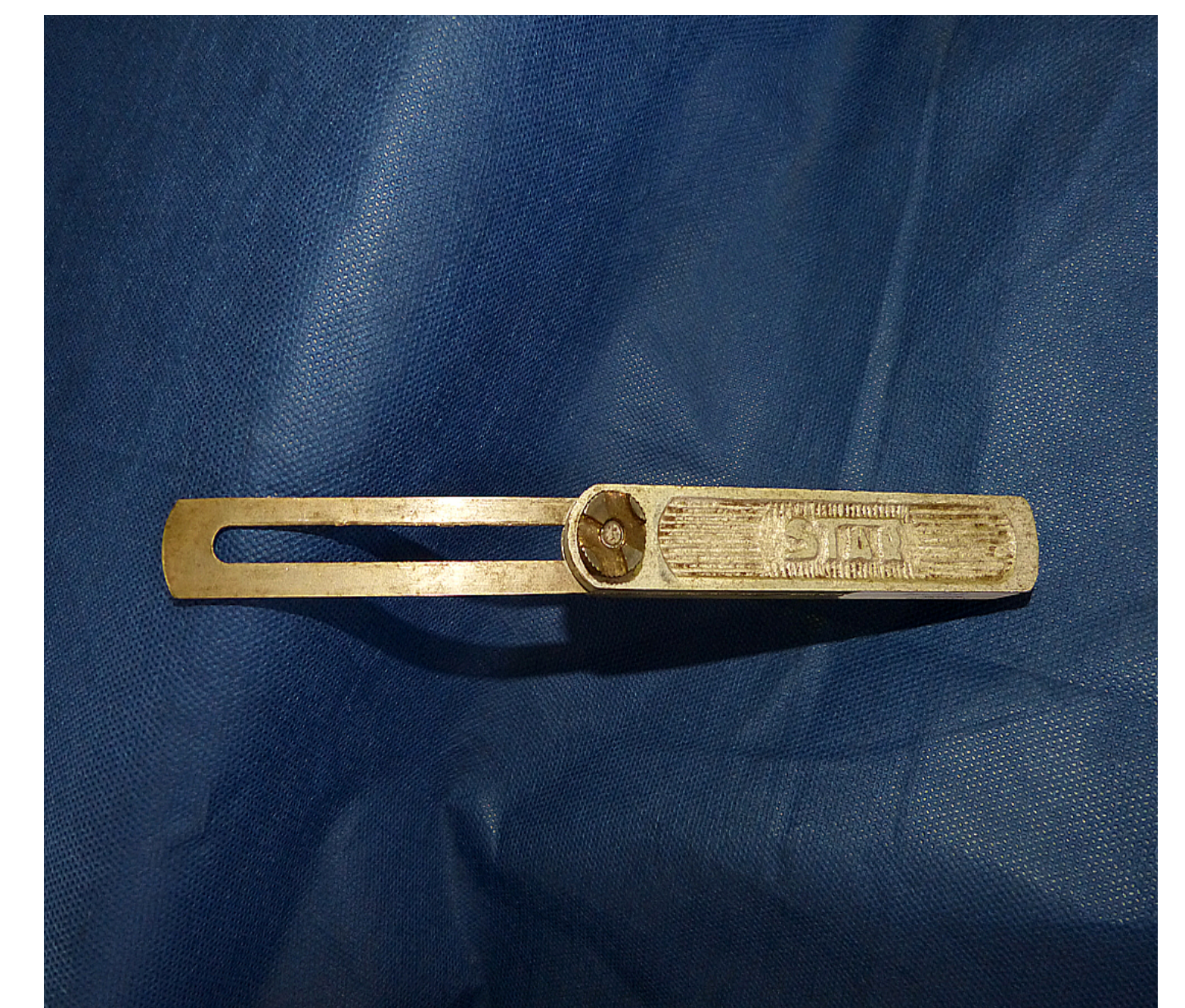
Figura 3 - Suta – instrumento ajustável usado para medir e traçar ângulos, composto por uma lâmina conectada à haste por meio de um parafuso e porca borboleta. Fotografia: Josiane Stahl, 06/04/2014.
