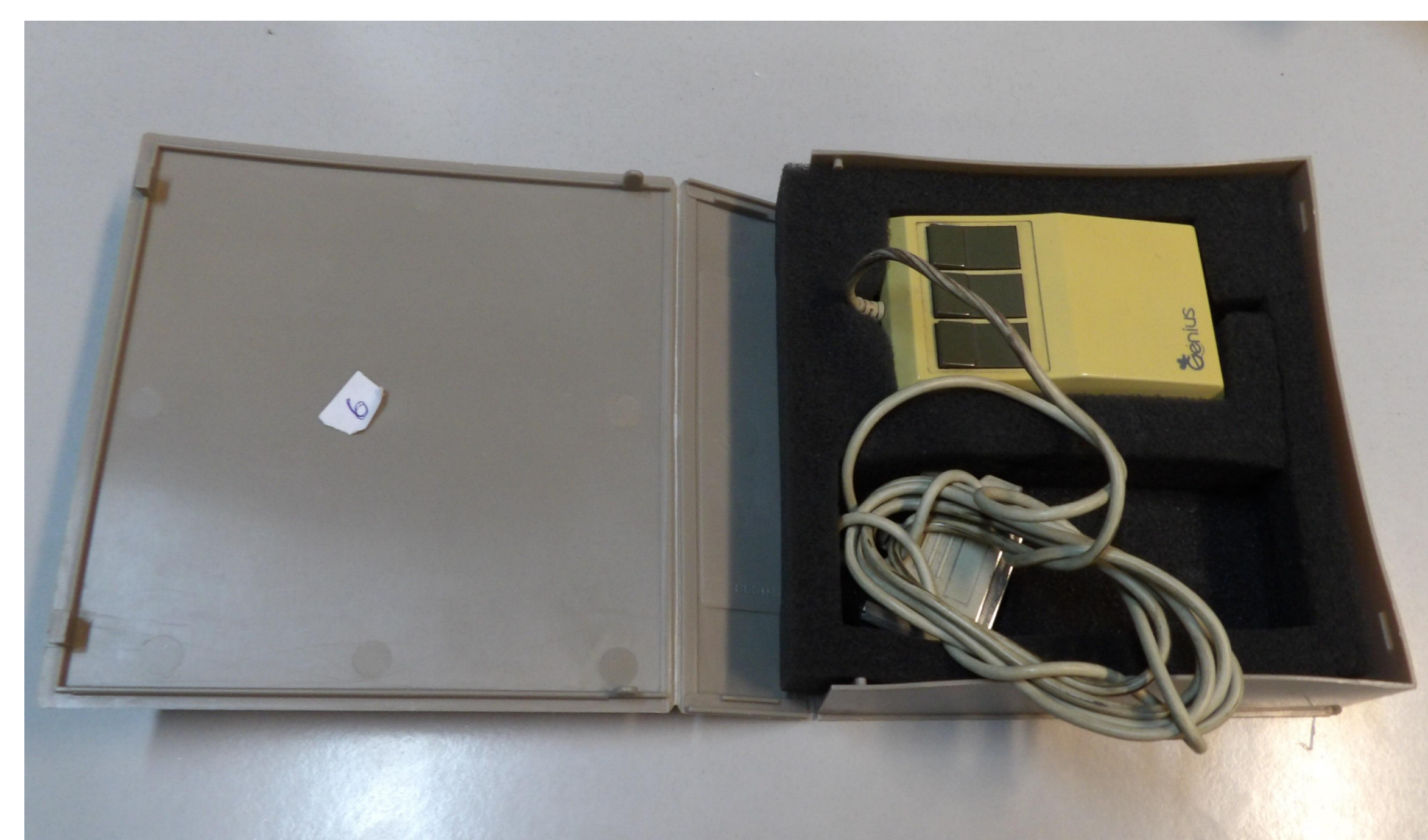
Figura 2 – Genius Mouse GM-6 PC Mouse – Mouse lançado no Mercado em 1989, possuía três botões e interface serial. Fonte: Material do Laboratório de conectividade da ETEC Sylvio de Mattos Carvalho, em 2015.
