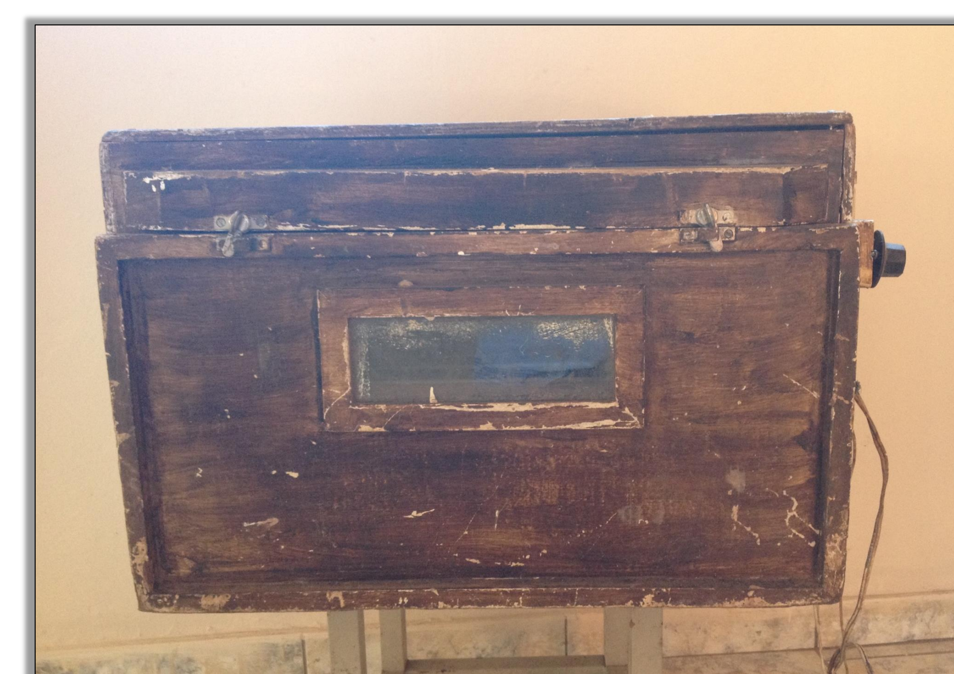
Figura 4: Chocadeira elétrica confeccionada pelo Professor Bigaram na década de 1990. Fonte: Acervo do Centro de Memória da Escola Técnica Estadual Professor Matheus Leite de Abreu, em 2015.
