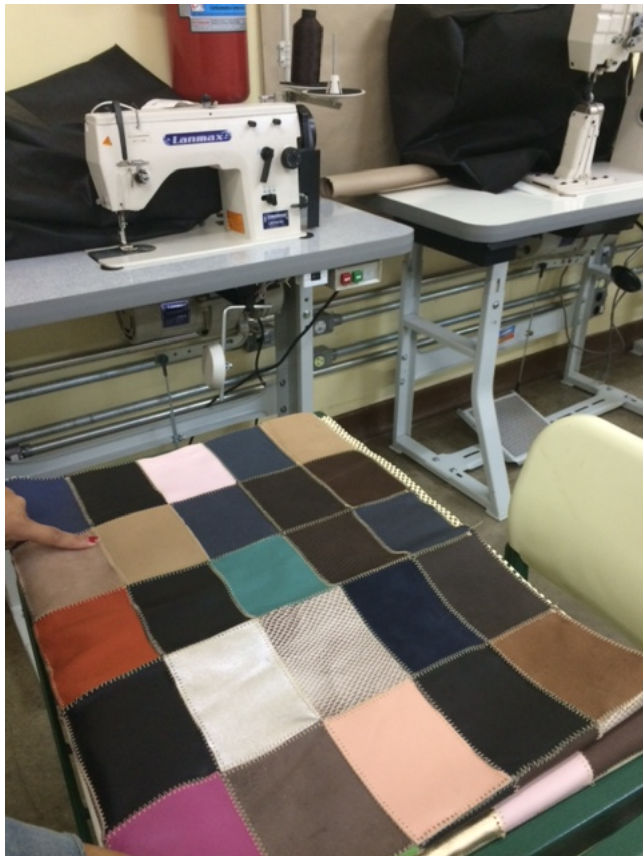
Figura 1: Tapete de couro produzido pelos alunos do Curso de Gestão da Produção Industrial, no Laboratório de Produção da Fatec Franca; ao fundo, máquina de "Zig" na qual se realiza este tipo de trabalho.
