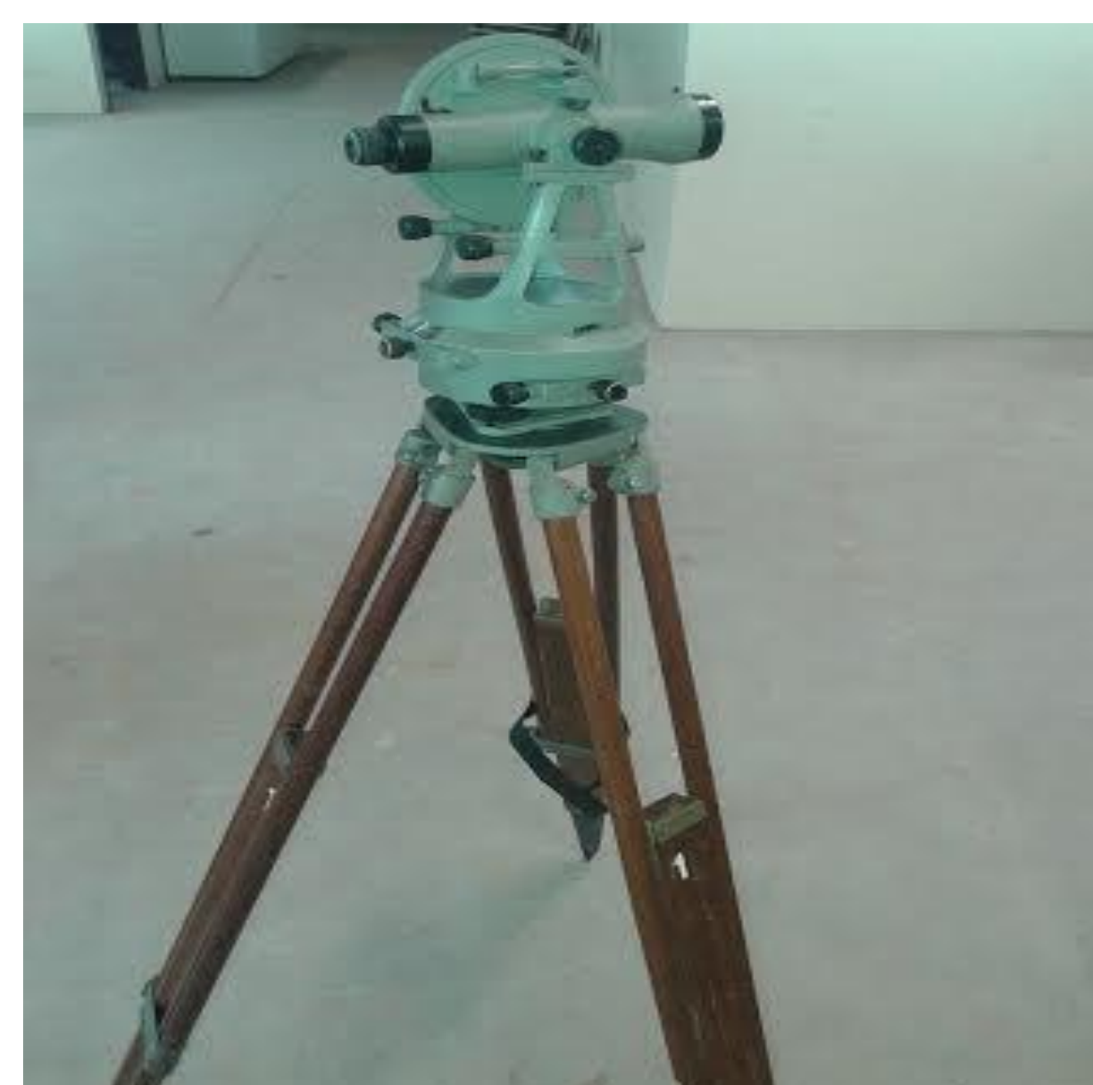
Figura 2 – Tripé de madeira com Teodolito
