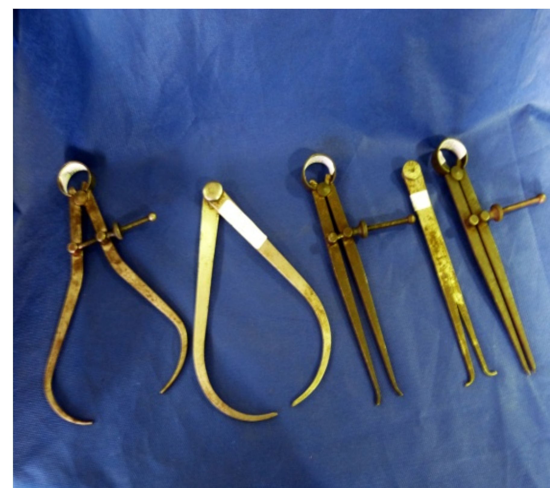
Figura 4 – Compassos (externo, interno, convencional ou de ponta) são instrumentos para transferir medidas, traçar ou riscar peças. Fotografia: Josiane Stahl, 06/04/2014.
