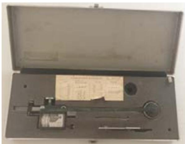
**Figura 13** - Planímetro Polar
