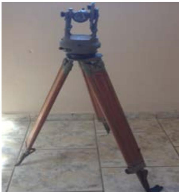
**Figura 12** - Teodolito Ótico Mecânico
