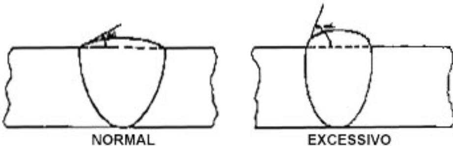
Ângulo excessivo de reforço – É um ângulo excessivo entre o plano da superfície do metal de base e o plano tangente ao reforço da solda, traçado a partir da margem da solda (Fig. 1). É causado por excesso de material de solda no acabamento.
