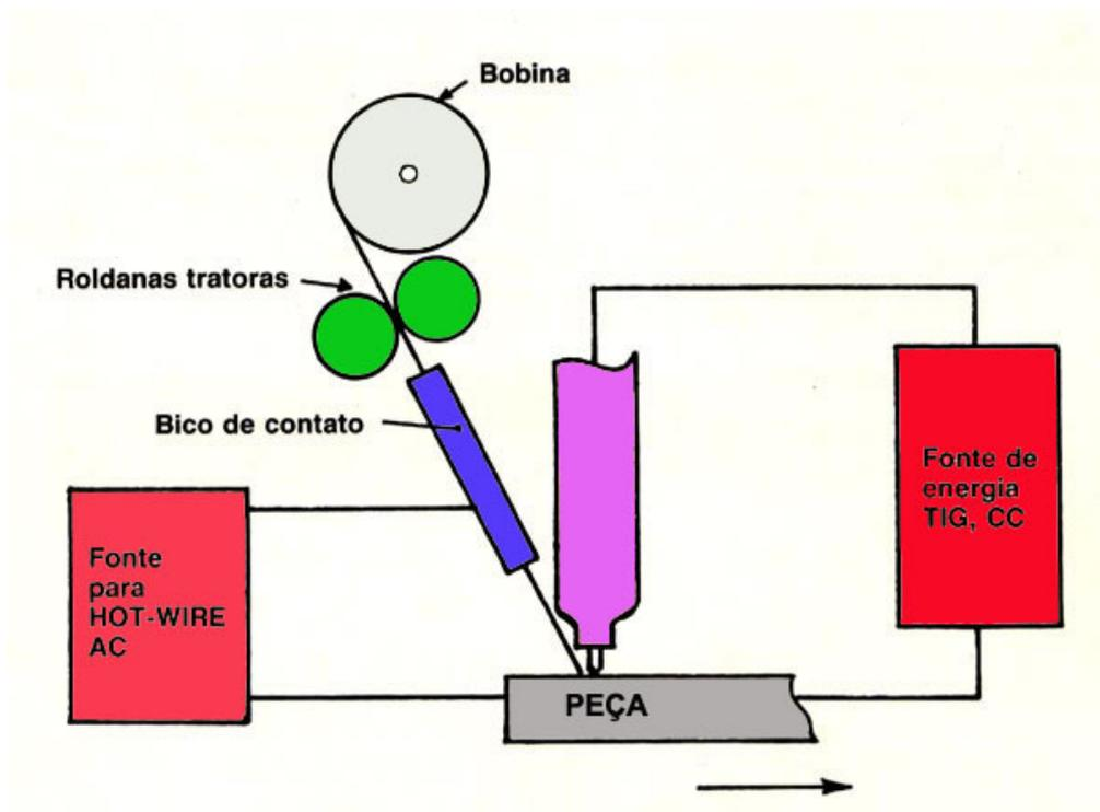
As varetas são utilizadas para os processos manuais, disponíveis em comprimento em torno de 1 m. Para os processos de alimentação automática se utilizam rolos de arame, similares ao do MIG, enrolados em bobinas de diferentes capacidades, com diâmetros variando entre 0,5 e 5 mm, aproximadamente.
