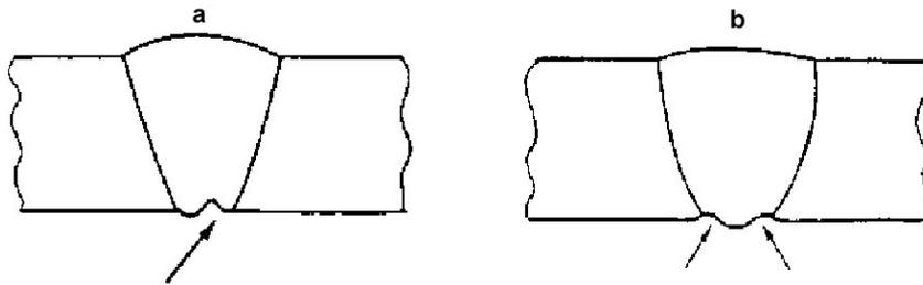
Concavidade – reentrância na raiz da solda, podendo ser: central, situada ao longo do centro de cordão (Fig. 3a); ou lateral, situada nas laterais do cordão (Fig. 3b). Geralmente é causada por movimentação rápida do eletrodo.
