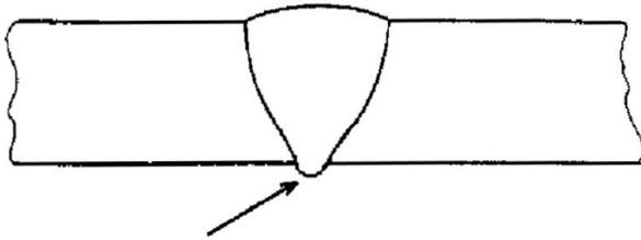
Penetração excessiva – Metal da zona fundida em excesso na raiz da solda
