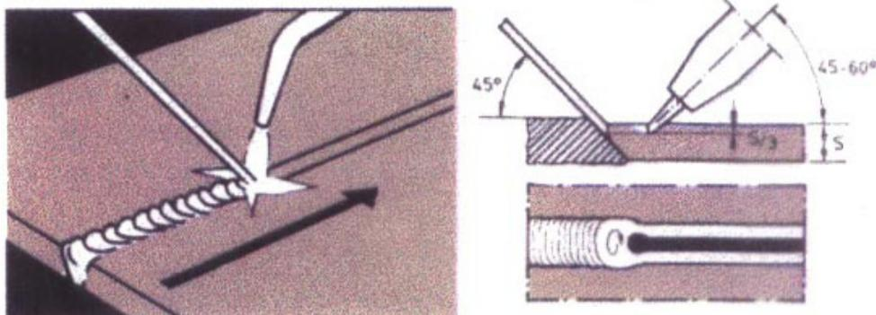
Solda a Direita: Também chamada de Solda para Trás, é utilizada quando a peça a ser soldada requer chanfros, ou seja, para espessuras maiores. É uma técnica desenvolvida durante a 2ª Grande Guerra, e que apresenta boa velocidade, boa penetração e economia de tempo e gases. Trabalha-se mantendo a união soldada aquecida.
