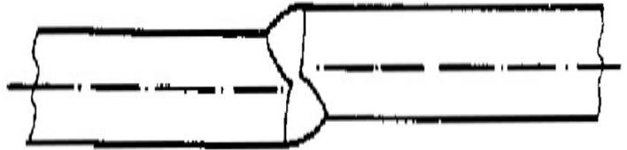
Desalinhamento – Junta soldada de topo, cujas superfícies das peças, embora paralelas, apresentam-se desalinhas, excedendo à configuração de projeto
