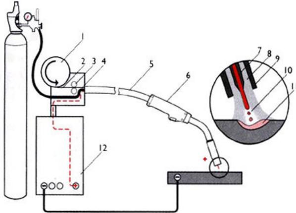
Princípio do processo MIG/MAG: 1. Carretel ou tambor 2. Eletrodo 3. Roletes de tração 4. Guia do arame 5. Conjunto de mangueiras 6. Pistola de soldagem 7. Bico de Contato 8. Gás de proteção 9. Bocal do Gás de proteção 10. Arco elétrico 11. Poça de fusão 12. Fonte de energia.
