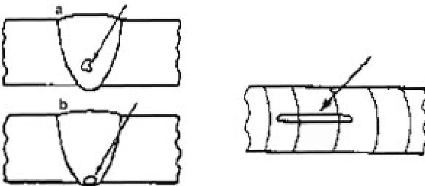
Cavidade alongada – Vazio não arredondado com a maior dimensão paralela ao eixo da solda, podendo estar localizado na solda (Fig. 2a); ou na raiz da solda (Fig. 2b). Pode ser causado por excesso de velocidade de soldagem.
