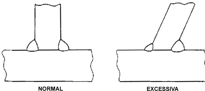
Deformação angular – Distorção angular da junta soldada em relação à configuração de projeto (Fig. 6), exceto para junta soldada de topo (Ver embicamento).
