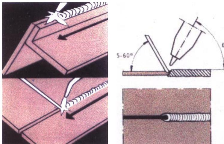
Solda a Esquerda: também chamada de Solda para a Frente, apresenta boa penetração e acabamento, sendo utilizada em espessuras de até 7 mm, onde se trabalha aquecendo a peça ou região a ser soldada. Apresenta grande consumo de gases e tempo.
